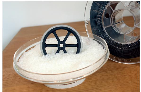
Von den sechs möglichen Kombinationen ist hier das Paar Direct Drive (links) und Pelletextruder (rechts) abgebildet. Die Felge (Bild rechts) wurde gedruckt mit einem Filament PLA NX2 schwarz (Direct-Drive-Extruder), der Reifen mit Pellets TPU hell Shore 27A (Schneckenextruder). © Picco
